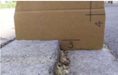
Testobjekt 1 (3/0) vertikaler Absatz, Höhe 3 cm
