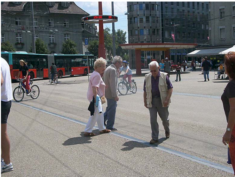
Figure 19 Place Centrale de Bienne, zone de rencontre: La chaussée est séparée de la surface piétonnière par une bordure oblique nettement détectable
