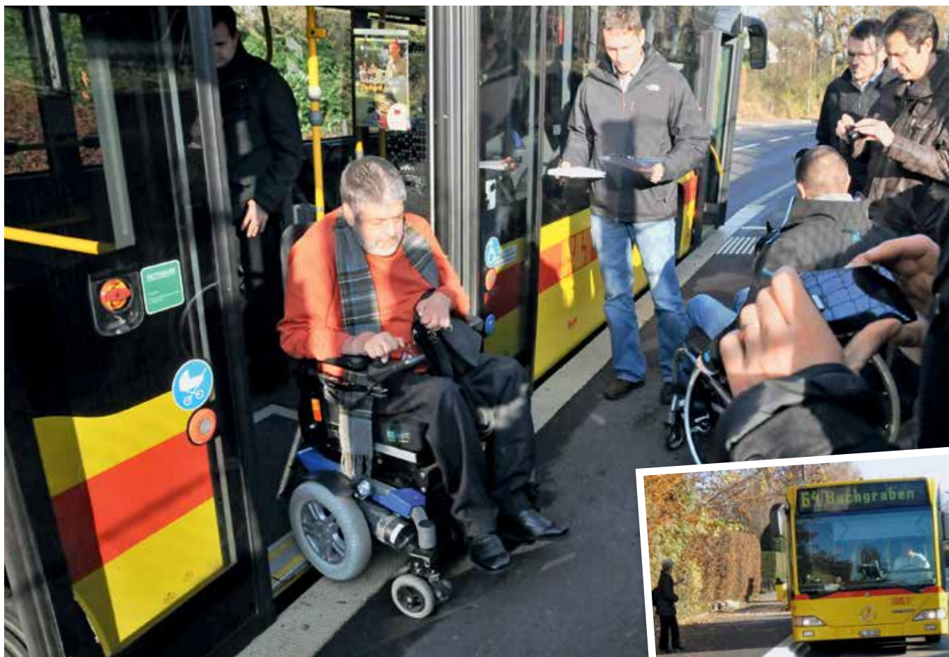
1 | Pilotprojekt in Therwil: Die Erfahrungen mit der niveaugleichen Haltestelle, die mit sogenannter hoher Haltekante (kl. Bild) realisiert wurde, sind durchwegs positiv (Foto:zvg). 1 | Projet-pilote à Therwil: les expériences faites avec les arrêts de bus de plain-pied réalisés «à bordure haute» [petite photo] sont tout à fait positives.
