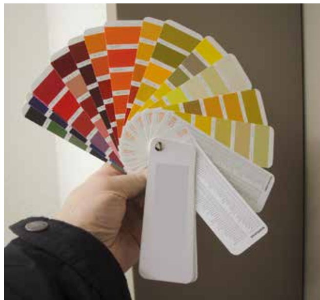
Estimation de la valeur relative de luminosité Y du cadre de porte avec un nuancier.
