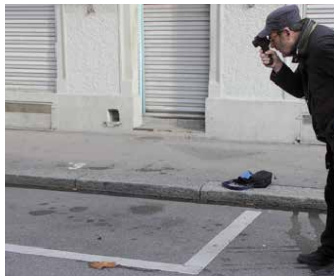
La luminance d'un objet et de son environnement est mesurée avec un luminancemètre selon la position de l'observateur.
