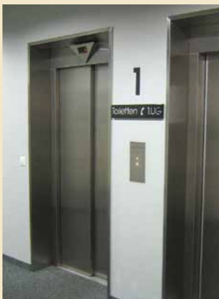
Le numéro d'étage au-dessus du bouton d'appel de l'ascenseur est bien visible.
