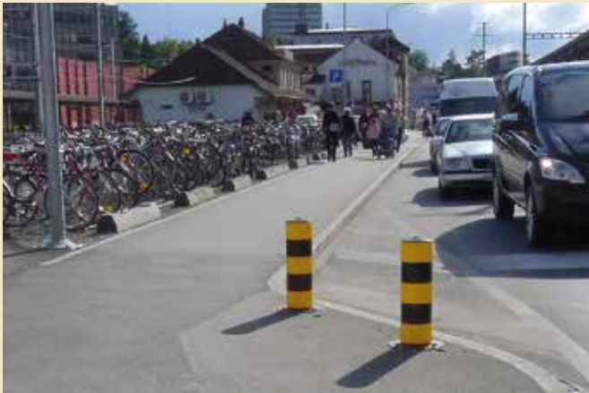
Pour la sécurité des véhicules, les bornes sont mises en évidence par du jaune et du noir. Cette signalisation aide aussi les personnes malvoyantes.
