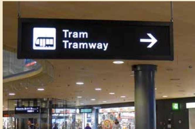
Pour des informations placées au-dessus de la tête, l'utilisation de caractères suffisamment grands est nécessaire. Sur ce panneau lumineux, l'écriture blanche offre un contraste de luminosité optimal avec le fond noir du support.
