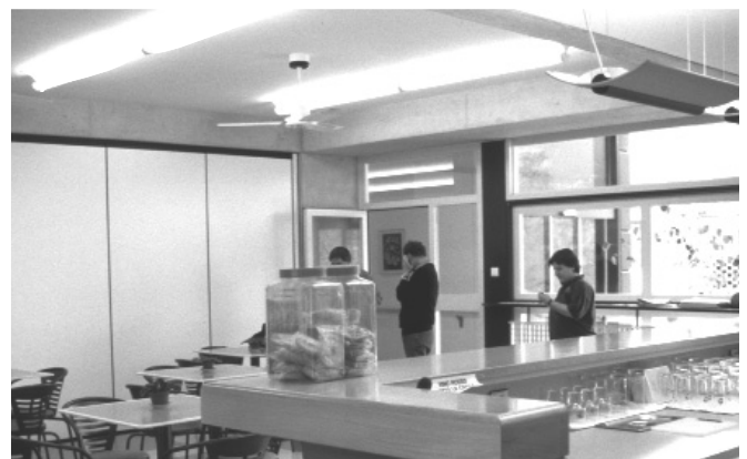
Gute, gleichmässige Ausleuchtung mit hohem Anteil von Indirektlicht im Casa Andreina, Lugano.
